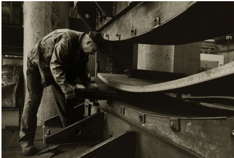
Dirk Reinartz, o. T. (Umformung einer von 10 Stahlplatten für die Skulptur „Dirk’s Pod“ in der Biegepresse bei Pickhan Umformtechnik in Siegen), 2003/04, © Dirk Reinartz Estate / Deutsche Fotothek und Stiftung F.C. Gundlach
